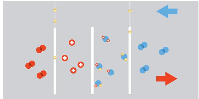
Vitovalor PA2 nutzt das Funktionsprinzip der Kraft-Wärme-Kopplung und erzeugt gleichzeitig sowohl Strom als auch Wärme. Als Energieträger wird dafür Wasserstoff eingesetzt, der zuvor aus Erdgas gewonnen wird.
