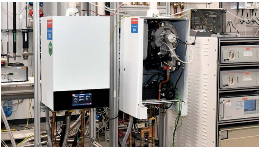
Erste Prototypen werden derzeit im Viessmann Technikum auf ihre Tauglichkeit für 100 Prozent Wasserstoff-Beimischung getestet.
